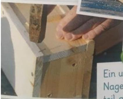
Nun nagelst oder schraubst du zuerst Bodenplatte und Rückwand zusammen. Dann kommen die Seitenwände, zuletzt die bewegliche Vorderfront, das Dach hinten die Aufhängeleiste.
