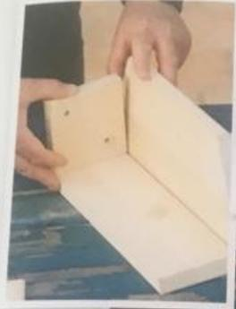
Zuerst wird der Boden an die Rückwand und ein Seitenteil genagelt oder geschraubt.
